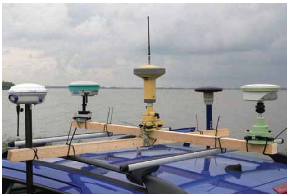
Расположение антенн на крыше автомобиля для проведения теста по передаче данных
